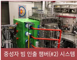
**용도** NBI-II(Neutral Beam Injection) 가열장치 빔라인 시스템
