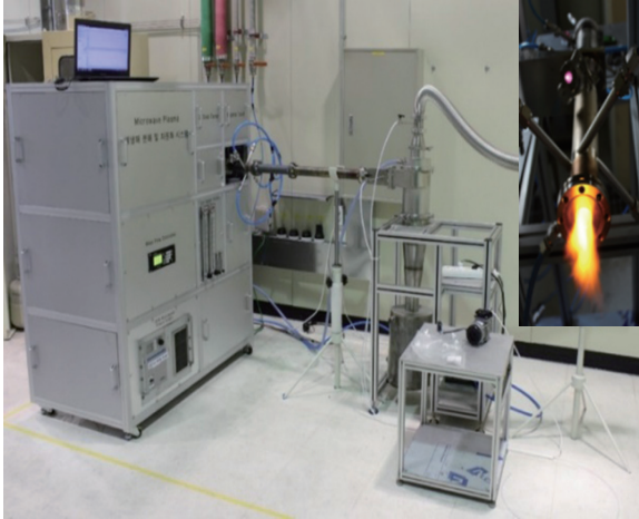
마이크로웨이브 플라즈마를 이용한 난분해성 폐가스를 분해하는 장치 ▲
